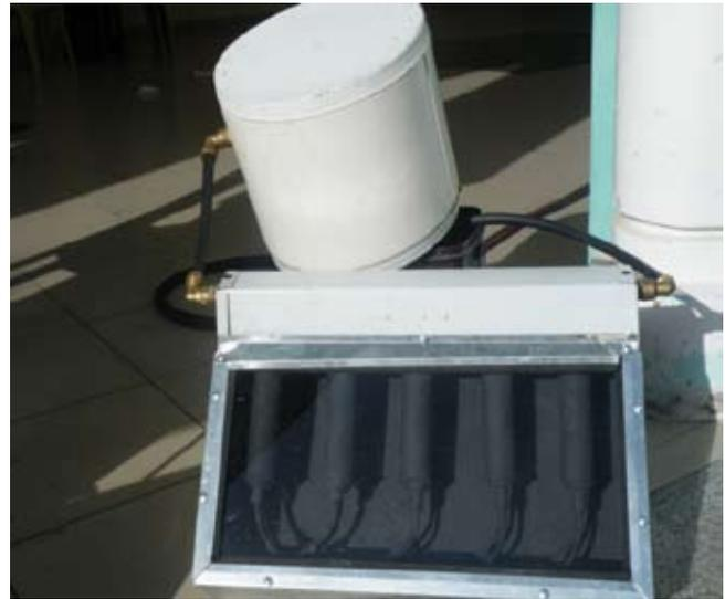
Fig. 4 : Solar Collector Assembled
