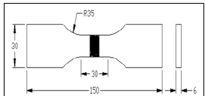
Fig. 1: Tensile Test Specimen
